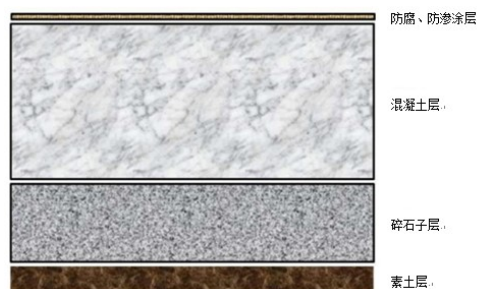
图 4-4 重点区域防渗层剖面图
